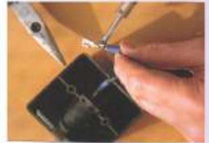
سبيكة الرصاص والقصدير تستخدم في لحيم التوصيلات الكهربائية.
