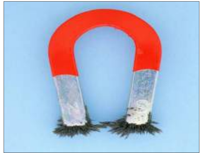
الشكل (9-c) تجمع برادة الحديد بتركيز عالي عند القطبين المغناطيسيين لمغناطيس بشكل حرف U.
