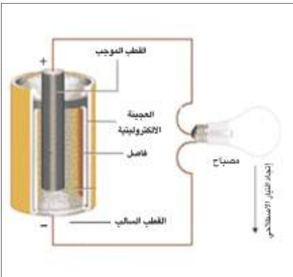
شكل (7) يوضح مقطع طولي تفصيلي للأجزاء المكونة لخلية (كربون - خارصين)
