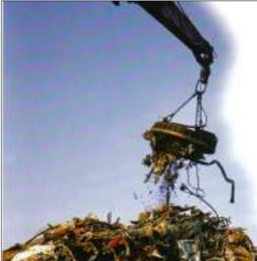
الشكل (18) مغناطيس كهربائي يستعمل لرفع
