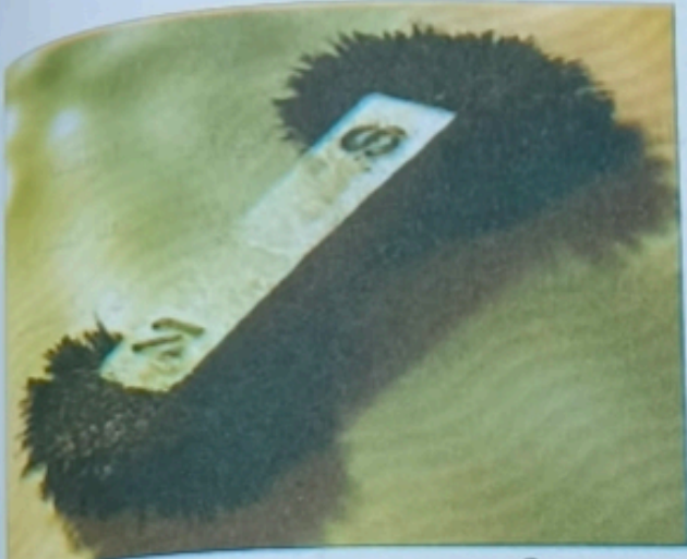
الشكل (9-a) يوضح تجمع برادة الحديد بتركيز عالي عند القطبين المغناطيسيين لساق مغناطيسية مستقيمة.
