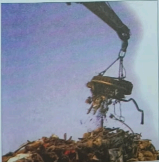
الشكل (18) مغناطيس كهربائي يستعمل لرفع الأثقال الكبيرة
