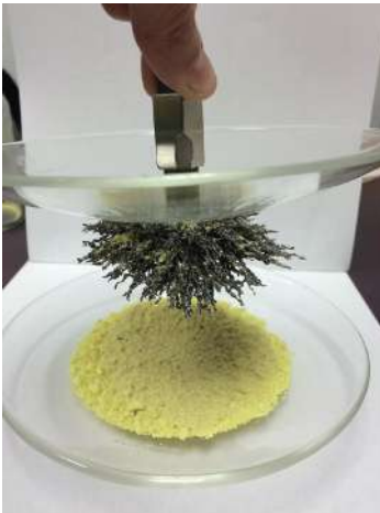
تتفصل برادة الحديد عن عنصر الكبريت بالمغناطيس
