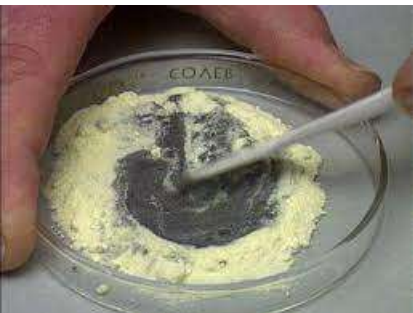
خلط برادة الحديد مع الكبريت
